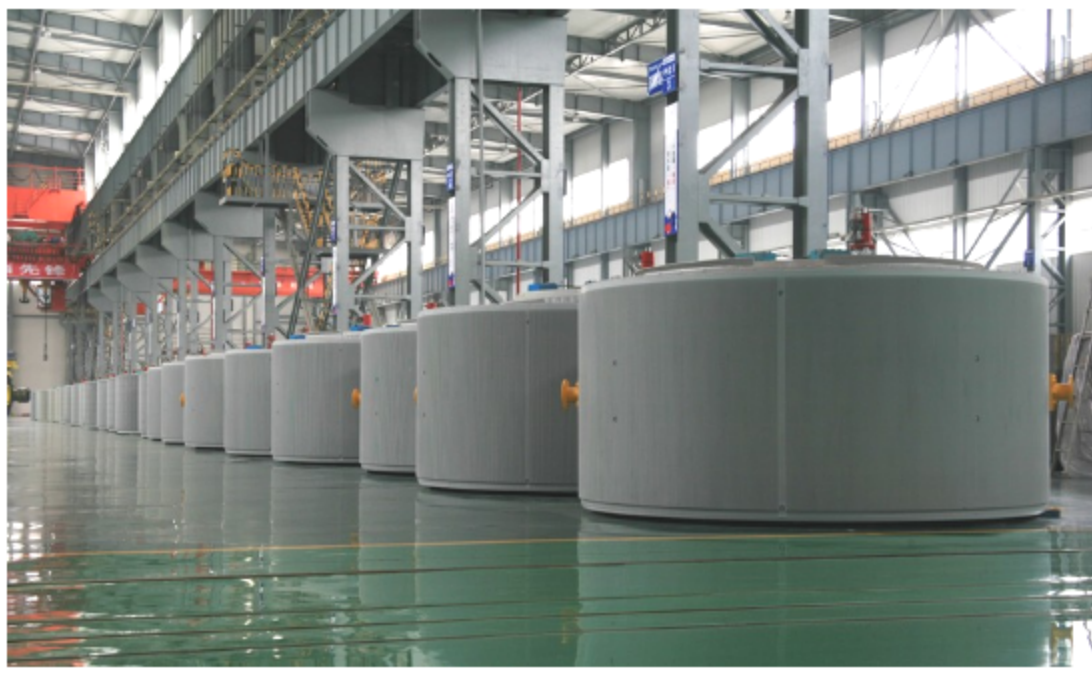
图 2 湘电永磁直驱风力发电机
